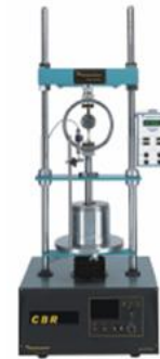
Gambar 7 Mesin uji CBR
